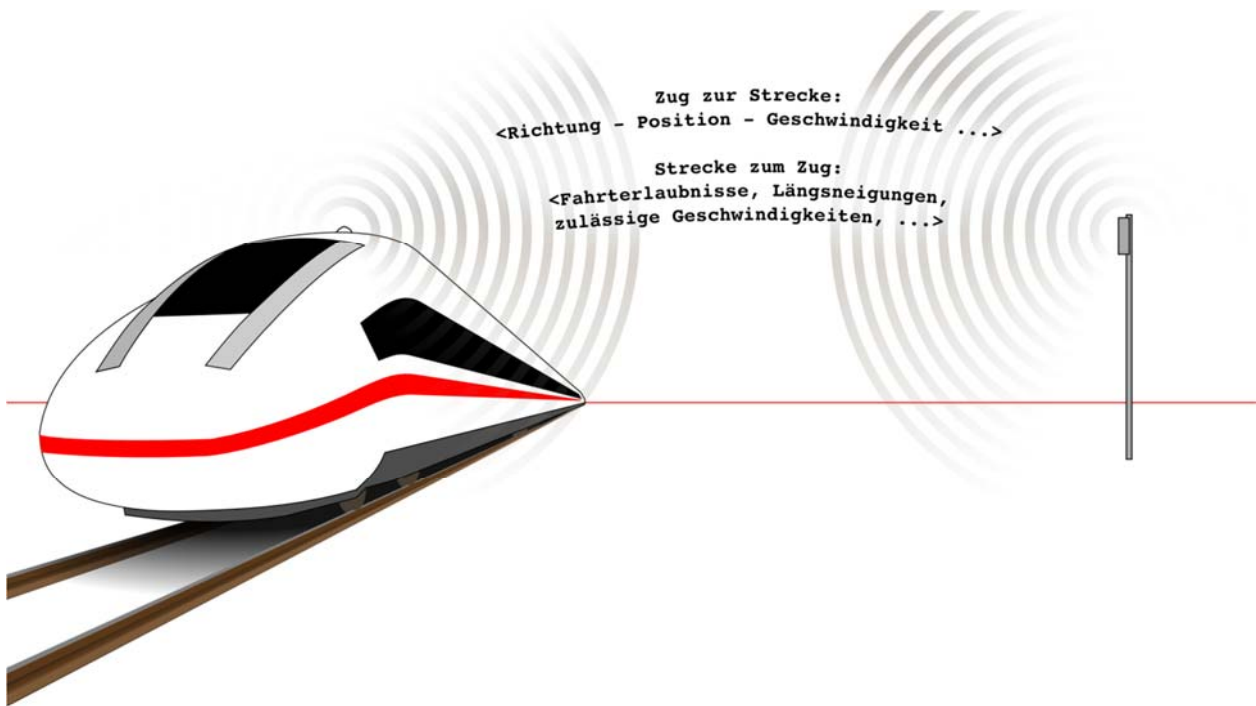
Abbildung 23: Mit ETCS stehen Zug und Strecke in einem laufenden Datenaustausch. Die gewonnenen Daten können zur Optimierung des Betriebs genutzt werden.
